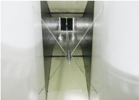
图 3 FL-20 风洞长轴探管(C-T) Fig.3 Long centerline probe (C-T) of FL-20
